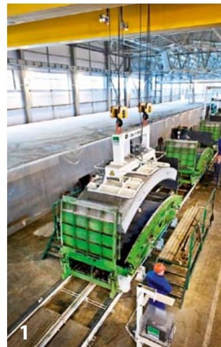
Belastungszustand eines Tübbings durch Ausschalen
