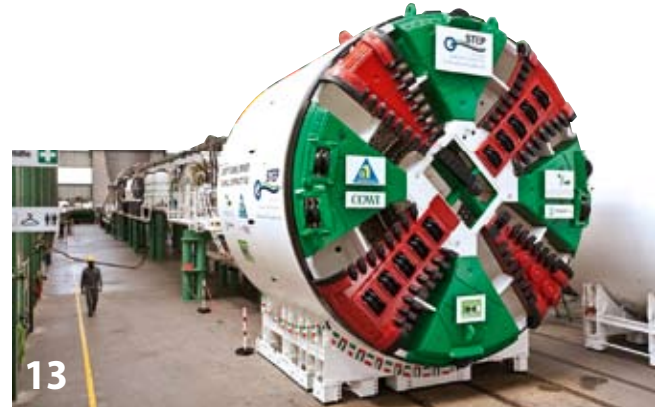
Tunnelbohrmaschine von Herrenknecht für das Projekt STEP in Abu Dhabi Herrenknecht tunnel-boring machine for the STEP project in Abu Dhabi
