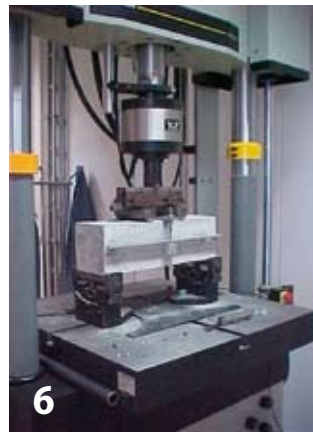
Balkenprüfung: 4-Punkt-Biege-Versuch (links) und Prinzipdarstellung des 3-Punkt-Biege-Versuchs (rechts) Beam test: four-point bending test (left) and view in principle of the three-point bending test (right)
