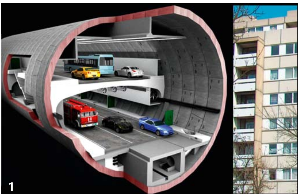
Orlovski Tunnel (zweistöckiger Autobahntunnel) mit sechsstöckigem Gebäude
